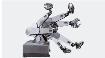
1973 hat KUKA den ersten Industrieroboter mit sechs elektromotorisch angetriebenen Achsen auf den Markt gebracht. ©KUKA
